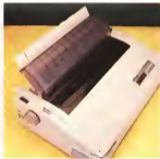
Le Fujitsu con il pannello di guida carta nelle due posizioni: posata in alto per il modo continuo e in basso per i fogli singoli.
